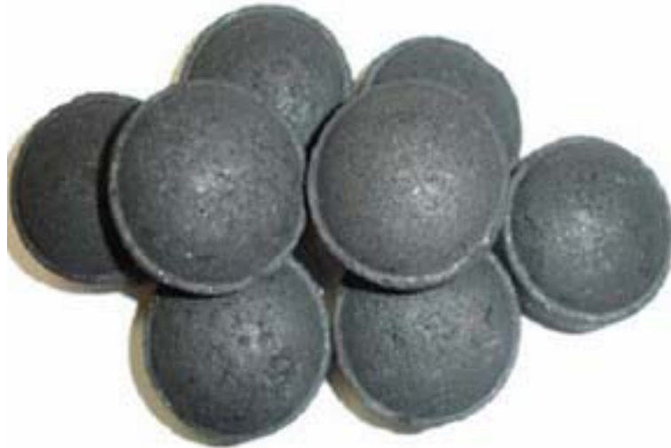
Рисунок 6.6 – Зразки брикетів з мулів очисних споруд
